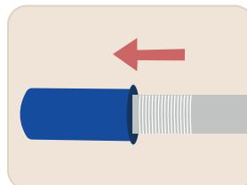
**2.** Das Ventil durch Ziehen öffnen und ca. 30 Sekunden warten, bis sich die Luftzellen selbstständig aufgeblasen haben.
