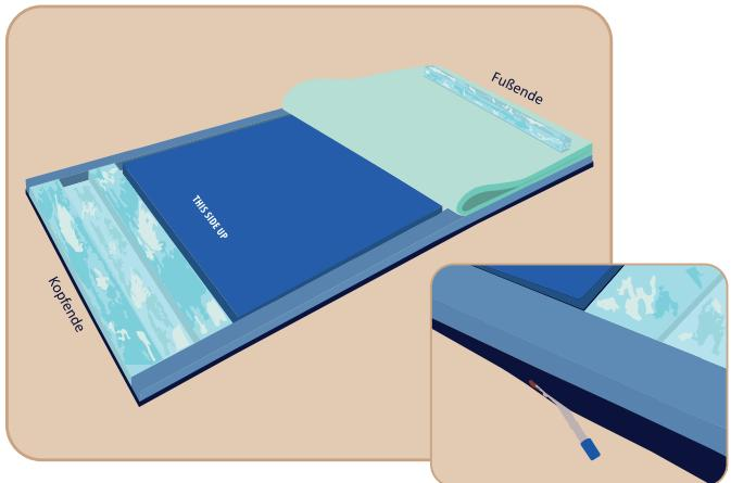
2. Die Oberplatte kann nun am Kopfende aufgeklappt werden. Darunter befindet sich der Luftzellenkreislauf in einem Bezug.
